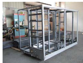
▲製缶+切削+精密板金の複合品
