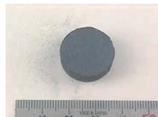
図3 SPS法により焼成されたMg<sub>2</sub>Si焼結
