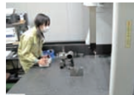
▲三次元測定による測定作業
