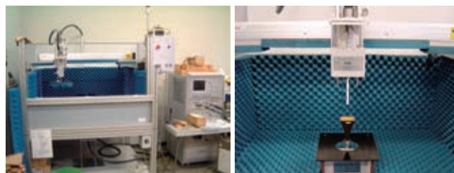
近傍界測定システム
