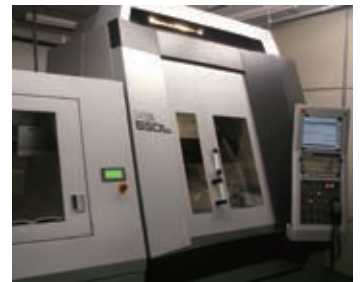
▲今回導入した高速高精度ミーリングマシン
