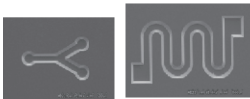
図3: これまでにない曲線パターンのエッチング
