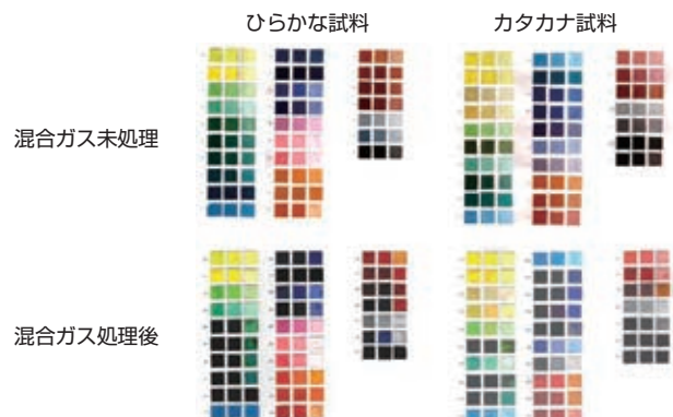
写真 当研究に用いた試作絵具描画試料(162種類)の混合ガス処理前後の外観(試験条件については文中)
