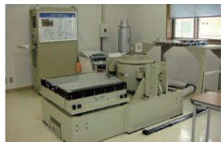
電子部品用高周波治具を取り付けて振動試験を行う状態
