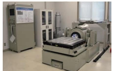
水平加振台に接続し、水平方向の振動試験を行う状態
