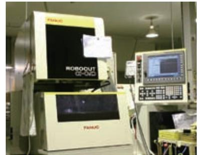
▲ワイヤーカット放電加工機(亀岡工場)
