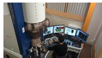
モノクロメータ搭載 低加速原子分解能分析電子顕微鏡
