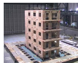
5階建て木造建築の振動台実験
